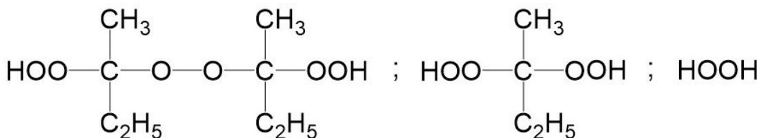
Butanox HBO-50 是一种快速凝胶的过氧化甲乙酮，在室温和升温条件下，和钴促进剂一起用于不饱和聚酯树脂的固化，例如：制造波形板。
