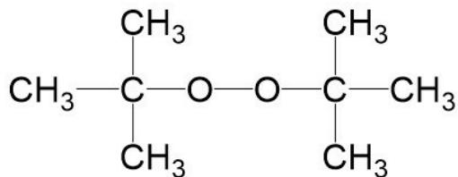
Trigonox® B-C90 是用于生产低密度聚乙烯的有效引发剂，既可以用于管式工艺，又可以用于高压釜式。在实践中，Trigonox® B-C90 通常与其他过不同活性的氧化物复合使用，以达到更宽泛的聚合温度范围。
